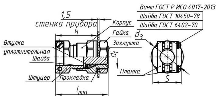
Рис. 4 – ЕхКВУ-Б – для прокладки бронированного кабеля
