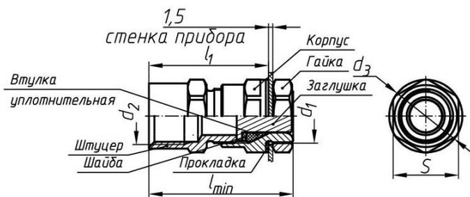
Рис. 3 – ЕхКВУ-М – для прокладки кабеля в металлорукаве
