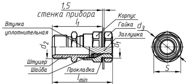
Рис. 2 – ЕхКВУ-Т – для прокладки кабеля в трубе
