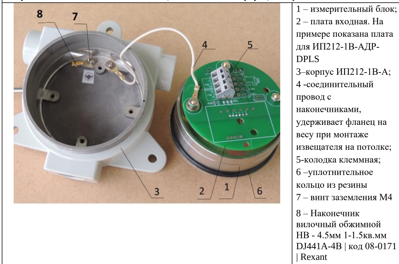
Рисунок Г.1- Извещатель ИП212-1В-А (в алюминиевом корпусе) без крышки
