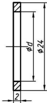
Рисунок А.19 – Шайба. Материал – сталь 09Г2С или сплав Д16Т. Размеры смотри в таблице А.9.
