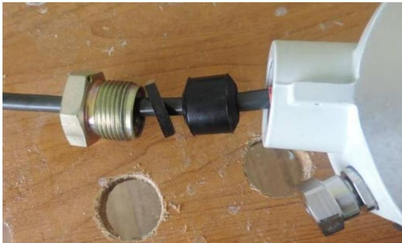
Вводимый кабель разделить на длину 50...60 мм. Жилы проводов зачистить на 5..6 мм, при возможности залудить. Экран кабеля (при наличии и необходимости оформить отдельным проводом длиной 60...70 мм и лепестком 5.
