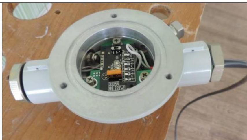
Справа установлен кабельный ввод К с кабелем диаметром 8 мм
