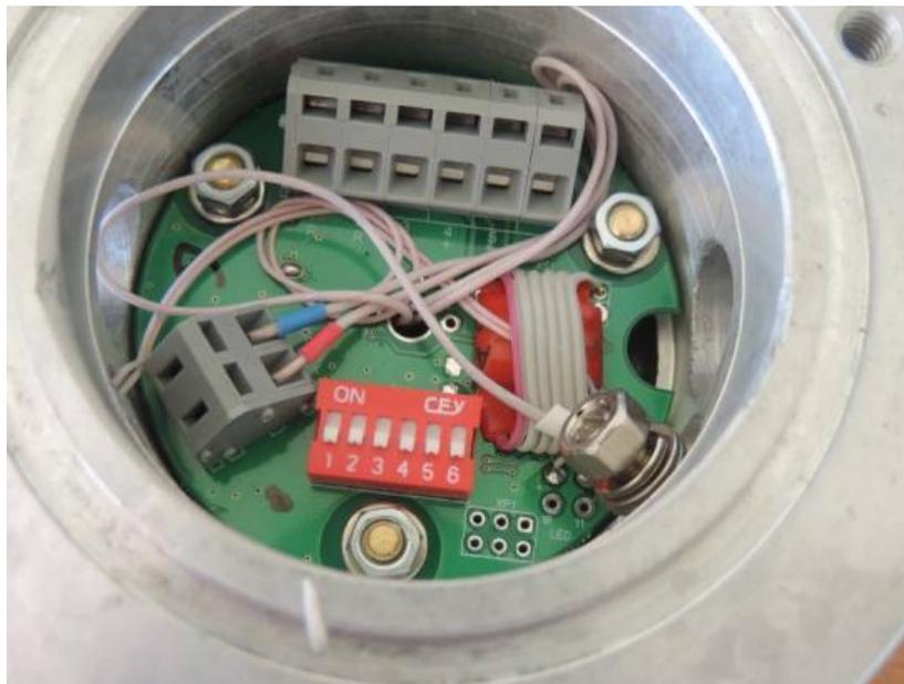
Рисунок А.7.б – Внешний корпуса без крышки адресных извещателей ИП101-1В-АДР-DPLS и ИП102-1В-АДР-DPLS. Схема включения адресных извещателей ИП101-1В-АДР-DPLS и ИП102-1В-АДР-DPLS показана на рисунке Б.4
