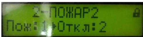
Рисунок 6.1 – Сигнал пожара на пульте С2000
