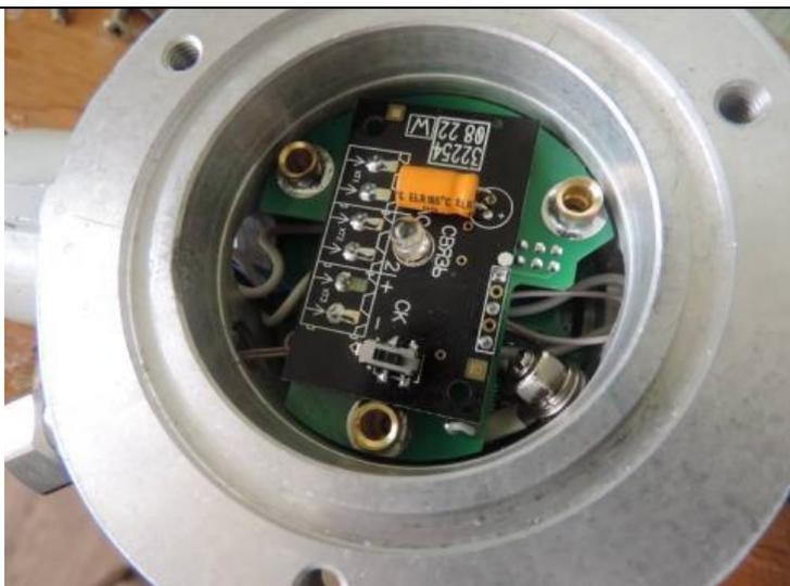
Аккуратно установить переходную плату в отверстия разъёма и отверстия под винты М4.
