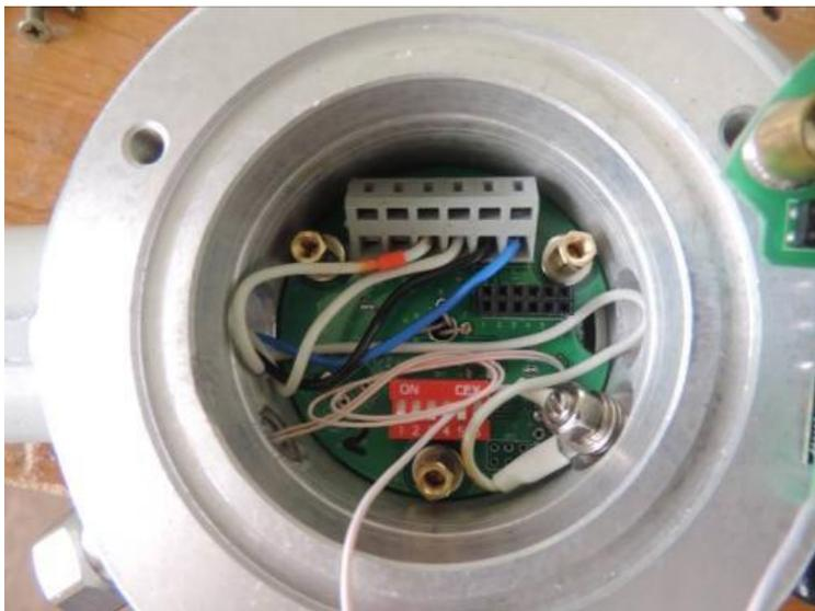
1. Жилы проводов с помощью отвертки с узким шлицем установить в клеммы согласно схемы соединений.
