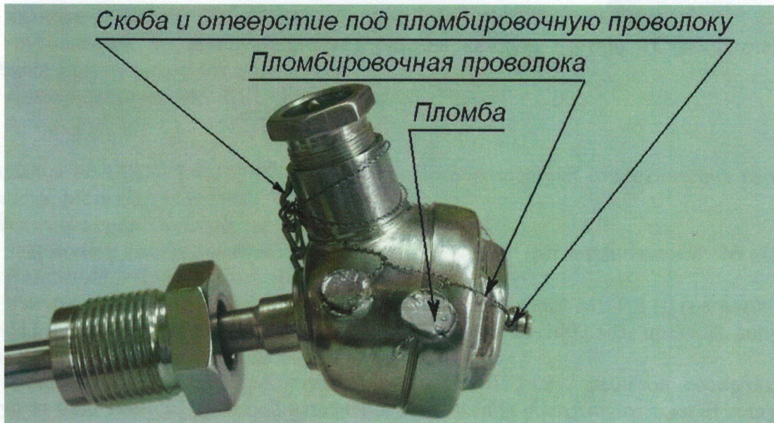
Рисунок 2 – Схема пломбирования ТС с металлическими головками
