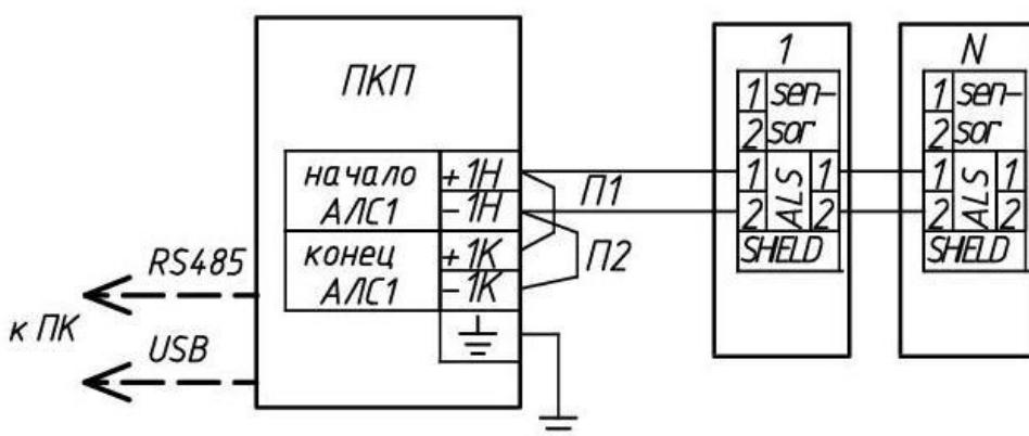
1, N – извещатели ИП101-1В-R3 и ИП102-1В-R3. Перемычки П1 и П2 включены для обеспечения кольцевой схемы ППКОПУ.
