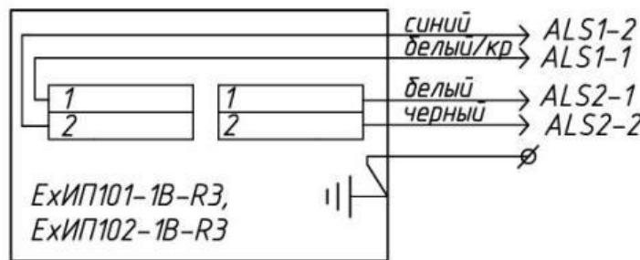
Рисунок Б.4 – Схема извещателей ИП101-1В-R3 и ИП102-1В-R3 с кабелем длиной не менее 1 м. Кабель предназначен для удобства подключения при сертификации.
