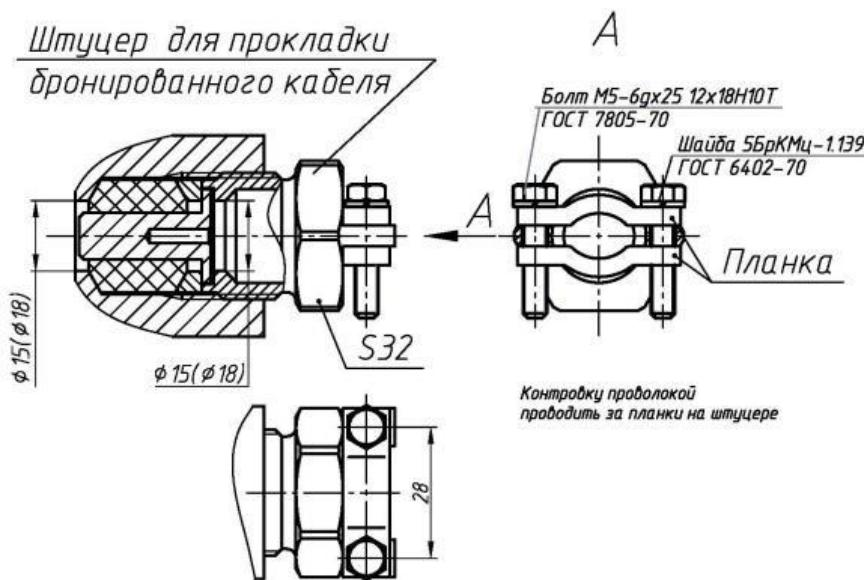
Рисунок А.11. Элементы взрывозащиты кабельного ввода для прокладки бронированного кабеля.
