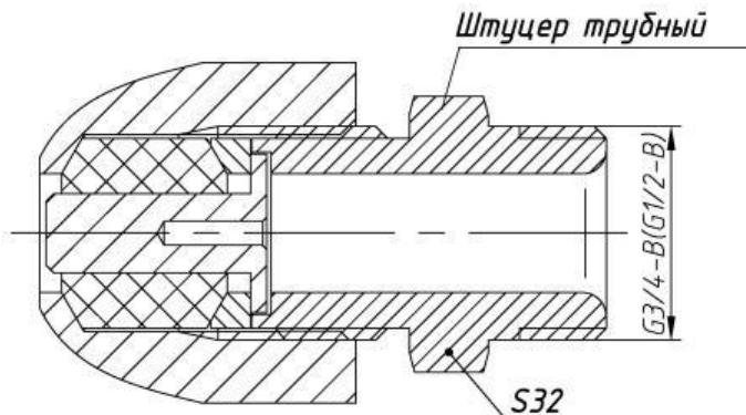
Рисунок А.10 Элементы взрывозащиты кабельного ввода для прокладки кабеля в трубе.
