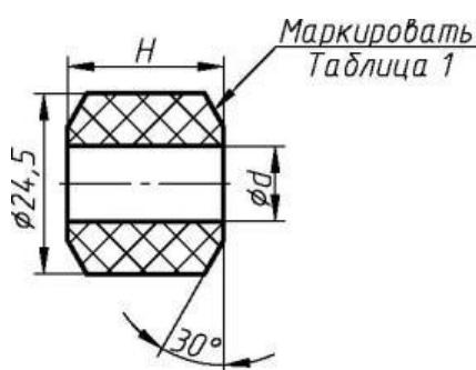
Рисунок А.12 Кольцо уплотнительное в свободном состоянии.
