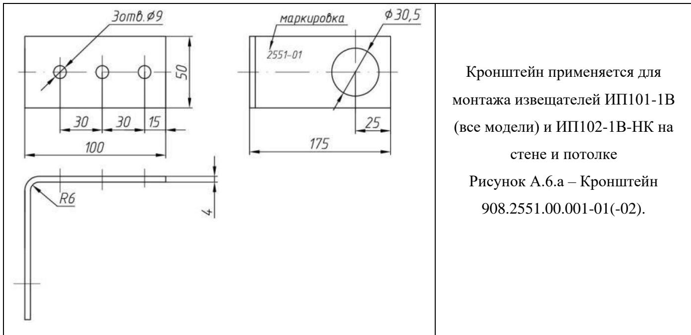
Кронштейн применяется для монтажа извещателей ИП101-1В (все модели) и ИП102-1В-НК на стене и потолке
