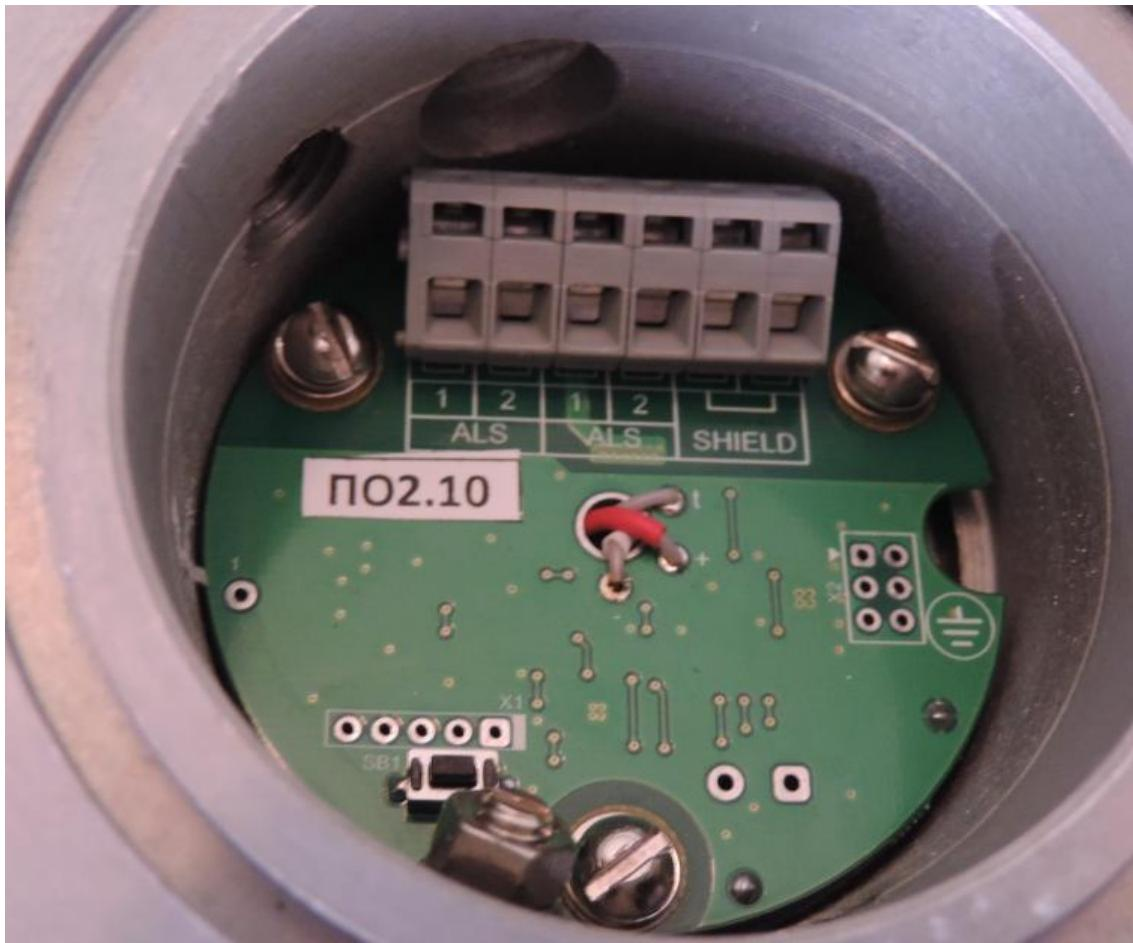
Рис. А.22 Маркировка версии программного обеспечения на плате ИП101-1В-R3
