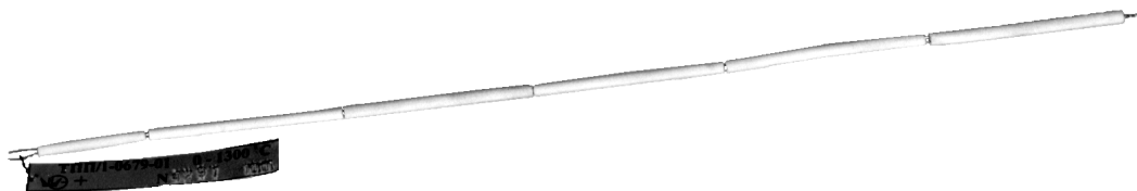
Рисунок 1 – Гибкая термопара с изоляцией керамическими изоляторами
