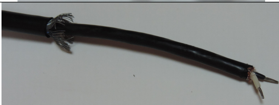
Рис. Г.2 – Разделанный бронированный кабель с диаметрами внутренней/внешней оболочек 8/11 мм, броня расположена между оболочками. Длина разделки внешней/внутренней оболочки – определяется потребителем. Длина разделанной брони от внешней оболочки – 10...12 мм
