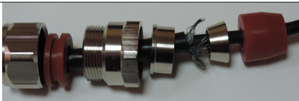
Рис. Г.3 – Разделанный кабель с разобранным кабельным вводом. Слева направо – гайка, кольцо уплотнительное для внешней оболочки, штуцер, конус внутренний, конус внешний, кольцо уплотнительное для внутренней оболочки. Корпус кабельного ввода с резьбой М20х1,5 не показан
