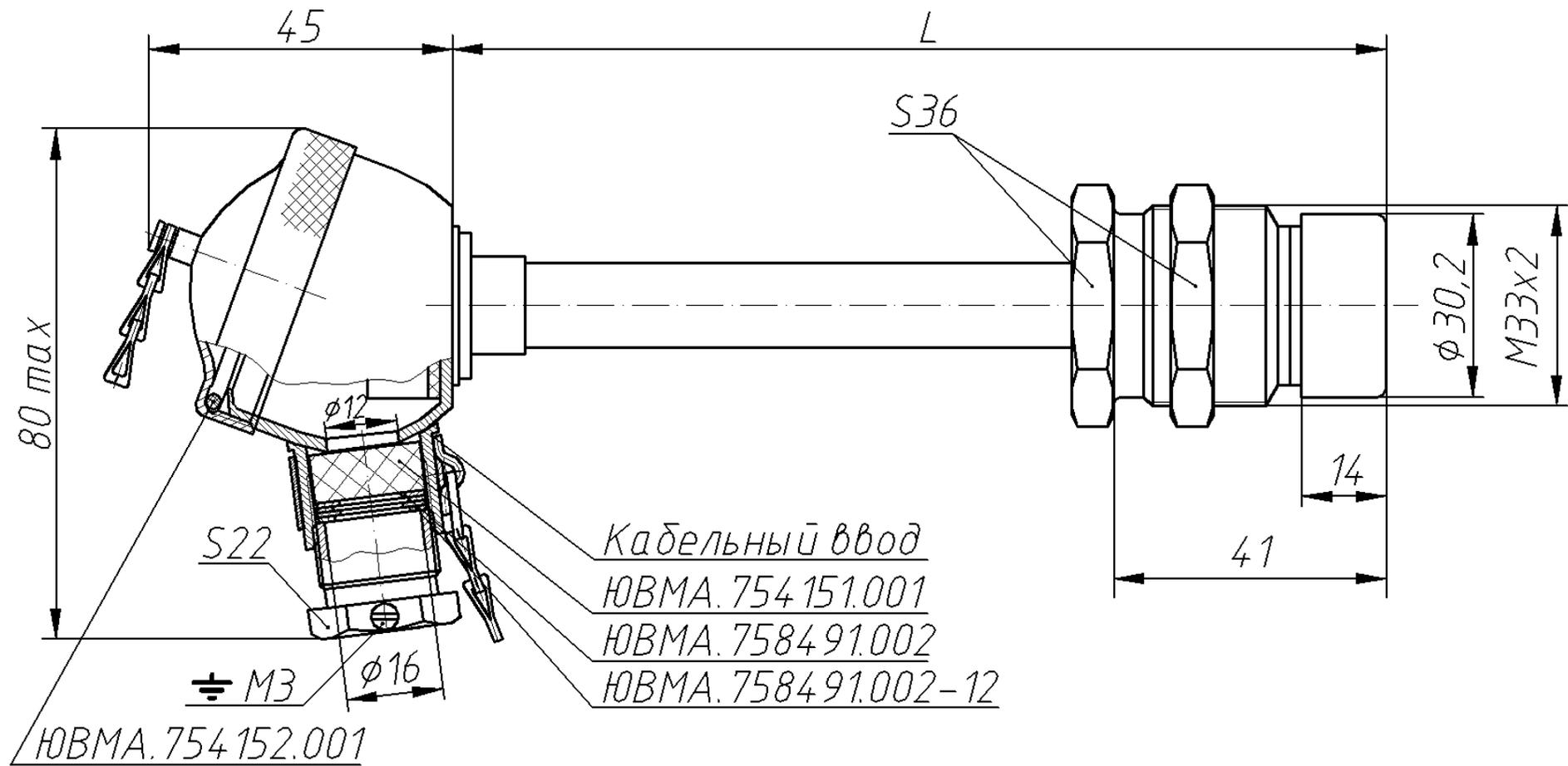
Габаритный чертеж термометра ТСП/1-8044
