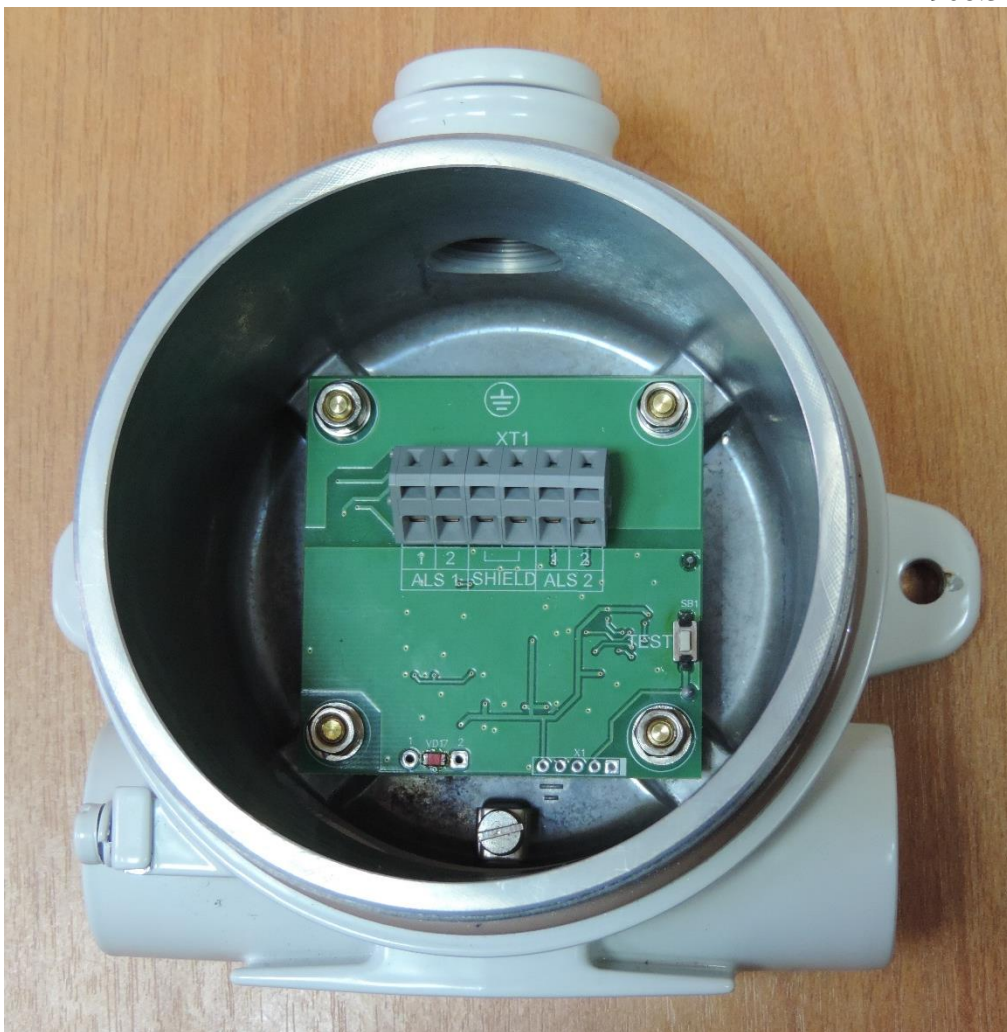
Рис. А.1.6 – Внешний вид коробки коммутационной ККВ14-ИЗ-1-Р3. Кабельные вводы не установлены, крышка снята.
